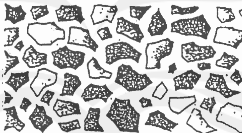
Gambar 2.2. Campuran Emulsi Bergradasi Terbuka
