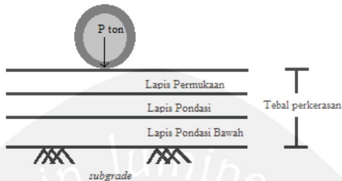
Gambar 2.1. Bagian Lapis Perkerasan
