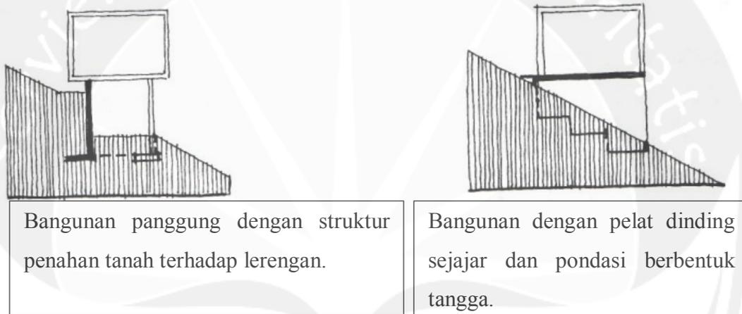
**Gambar 6.16. Pondasi Bangunan pada Kontur**
