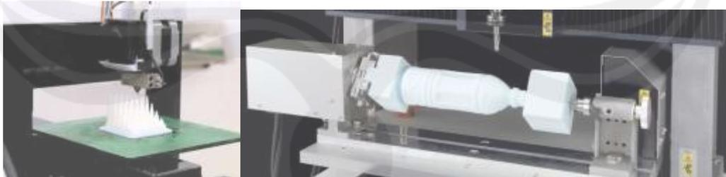
**Gambar 2. 2. Teknologi RP, 3D Printing (kiri) dan 4-axis CNC Milling (kanan)**
