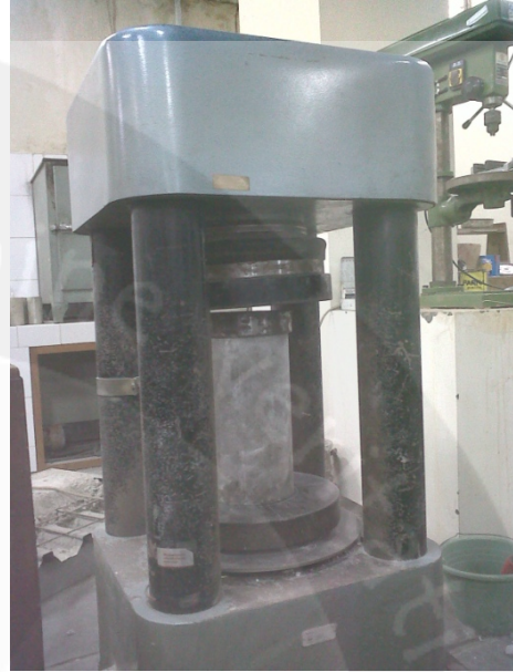
Silinder Beton S5 umur 14 Hari
