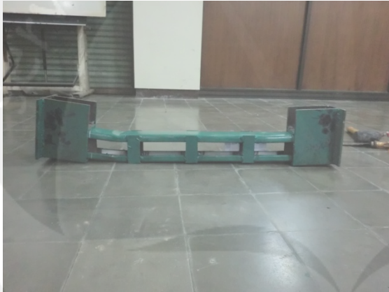
Kolom Profil C Ganda Tak Berpengisi Beton Ringan Setelah Pengujian (KPK-200)
