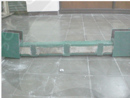
Kolom Profil C Ganda Berpengisi Beton Ringan Setelah Pengujian
