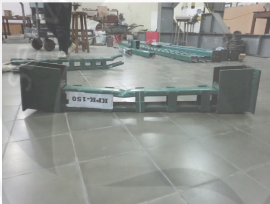
Kolom Profil C Ganda Tak Berpungsi Beton Ringan Setelah Pengujian (KPK-150)
