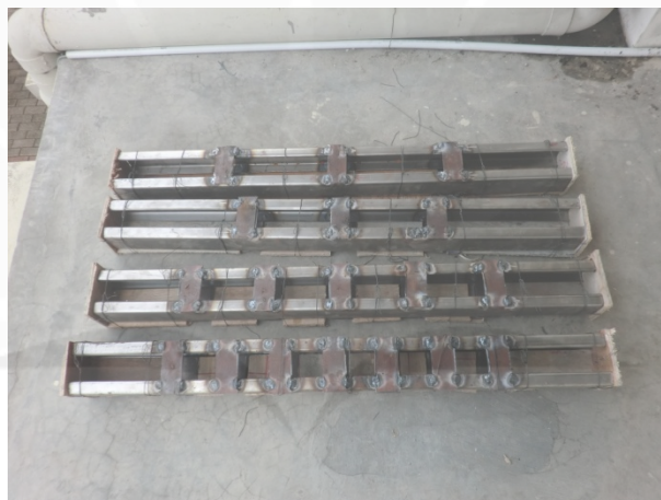
Bekesting Benda Uji
