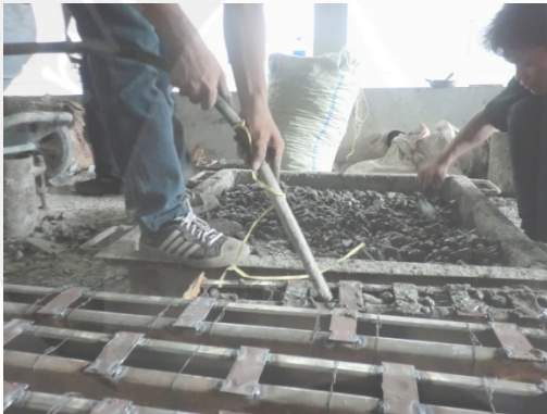
Pengecoran Benda Uji
