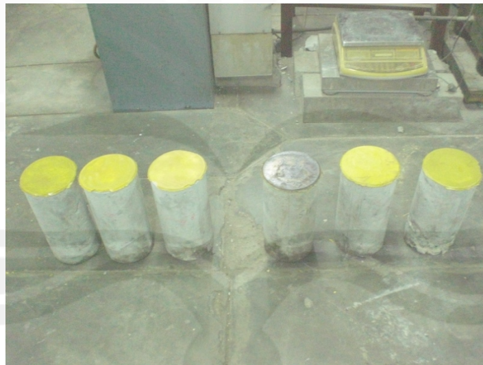
Pembuatan Caping Silinder
