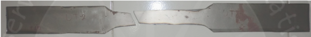
Sampel Baja Profil C Setelah Diuji
