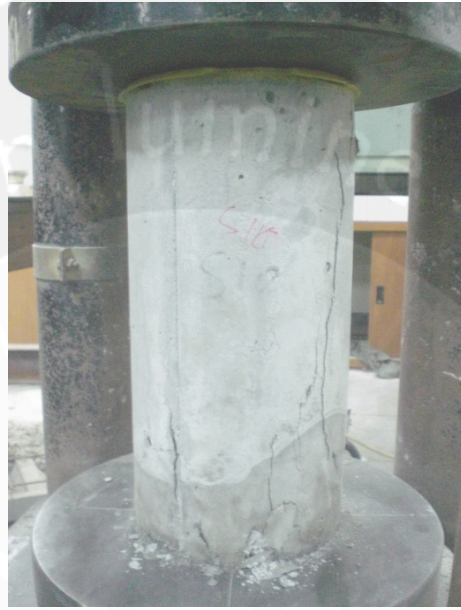
Silinder Beton S10 umur 28 Hari
