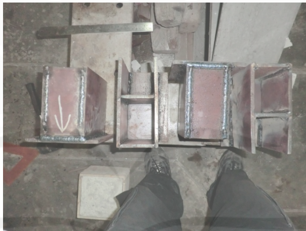
Pembuatan Penumpu Beban Eksentrik
