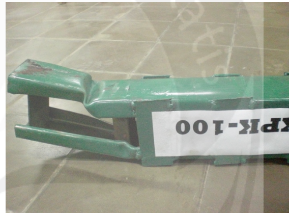
Kolom Profil C Ganda Tak Berpengisi Beton Ringan Setelah Pengujian (KPK-100)
