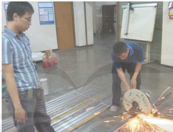
Pemotongan Profil C
