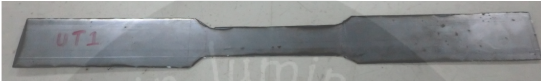
Sampel Baja Profil C Sebelum Diuji
