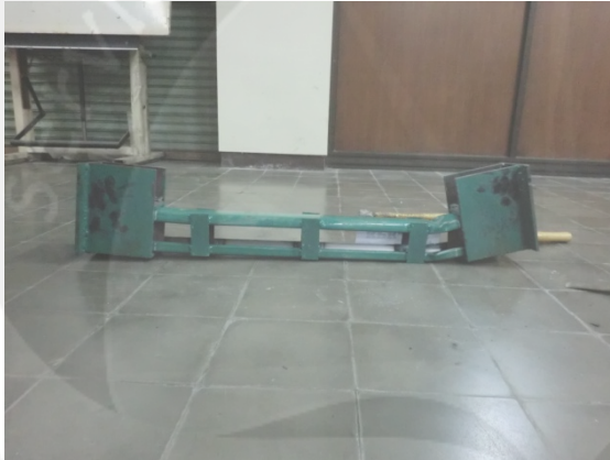
Kolom Profil C Ganda Tak Berpengisi Beton Ringan Setelah Pengujian (KPK-250)
