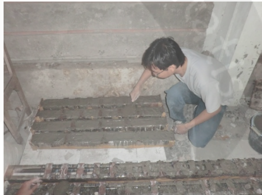
Pengecoran Benda Uji
