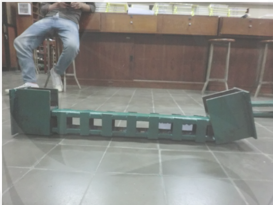
Kolom Profil C Ganda Tak Berpengisi Beton Ringan Setelah Pengujian (KPK-100)
