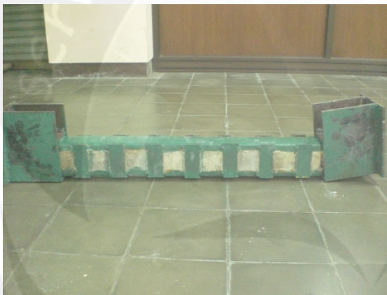
Kolom Profil C Ganda Berpengisi Beton Ringan Setelah Pengujian (KPB-100)
