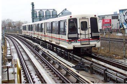
Gambar 2.4 Jalur Scarborough RT di Toronto Ditenagai Oleh Motor Induksi Linier
