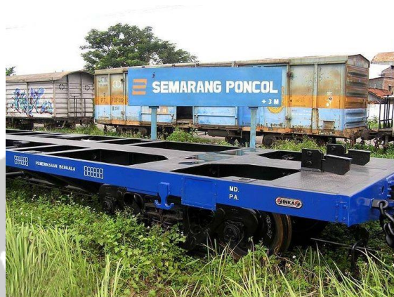
Gambar 2.14 Gerbong Datar Tipe PPCW
