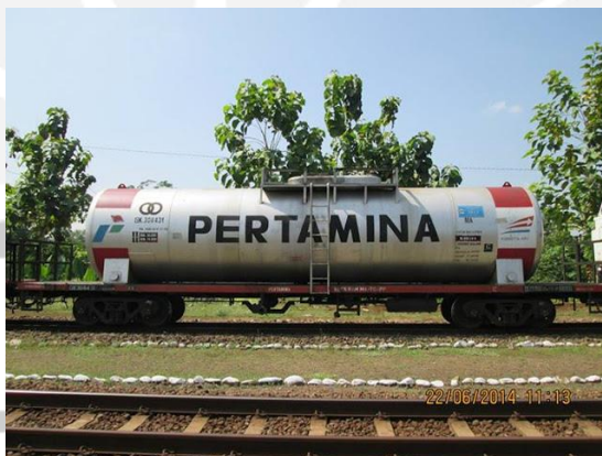
Gambar 2.17 Gerbong Pengangkut BBM
