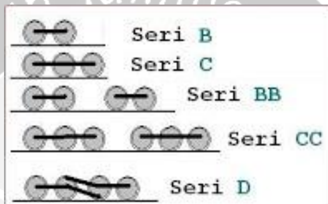
Gambar 2.13 Kode – Kode Roda Lokomotif
