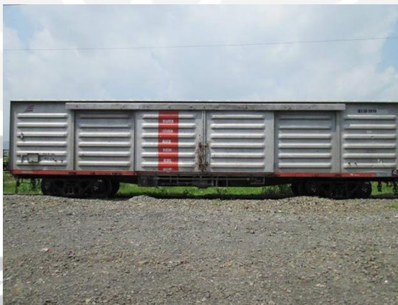
Gambar 2.15 Gerbong Tertutup Pengangkut Semen
