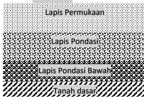
**Gambar 3.1 Susunan Lapis Perkerasan Lentur**
