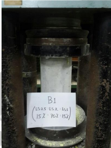
Pengujian Kuat Tekan Beton
