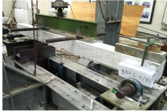
Balok sebelum dilapisi Fiber
