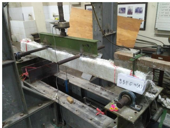
Balok sesudah dilapisi Fiber
