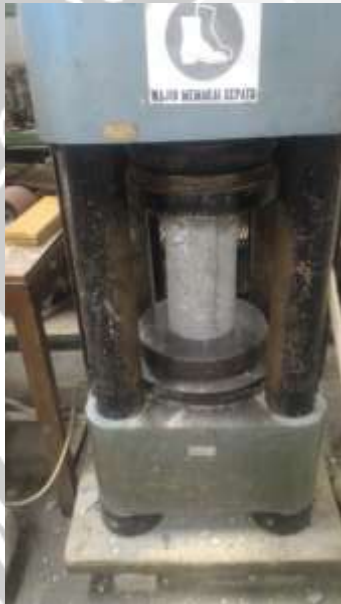
Pengujian Kuat Tekan Beton
