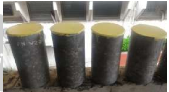
Benda Uji Setelah Dikaping
