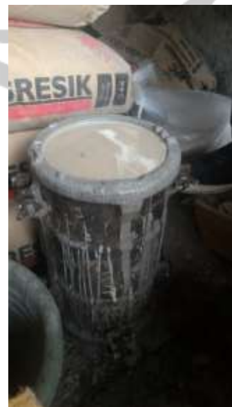
Penuangan Campuran Beton Kedalam Silinder
