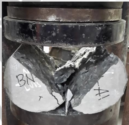
9. Hasil Pengujian Kuat Tarik Belah Beton Normal
