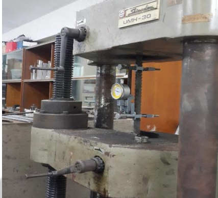
1. Pengujian Kuat Tulangan Baja
