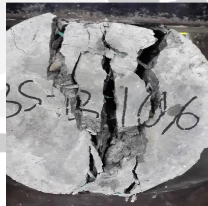
10. Hasil Pengujian Kuat Tarik Belah Beton Serat
