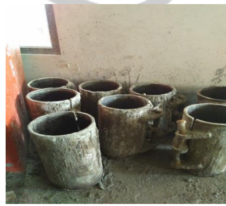
12. Cetakan Silinder Beton
