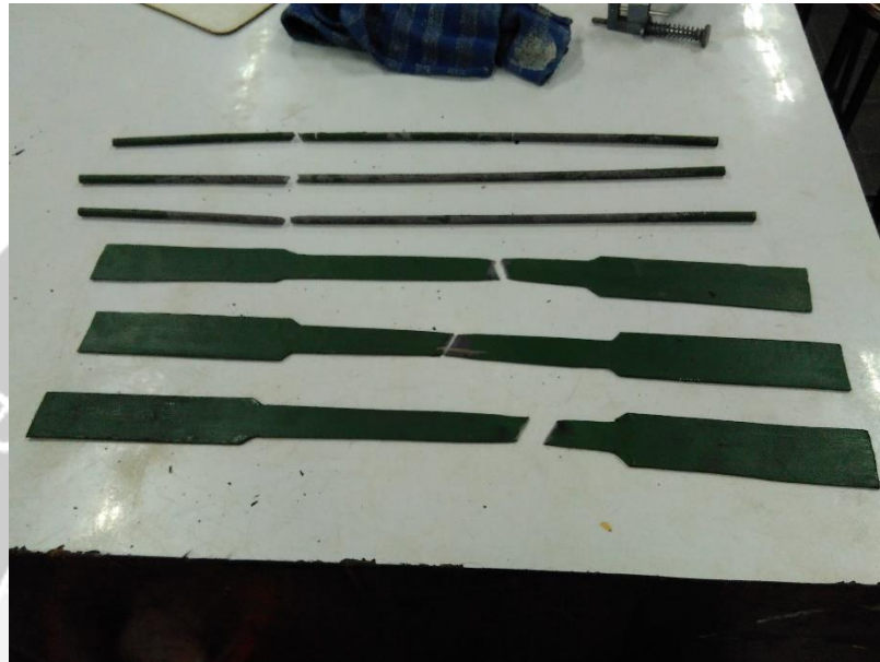
Pengujian Sampel Baja
