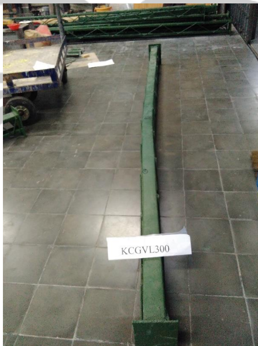
Kolom Setelah Pengujian (KCGVD300)
