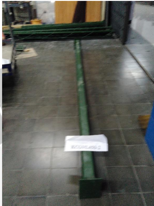
Kolom Setelah Pengujian (KCGVD450)
