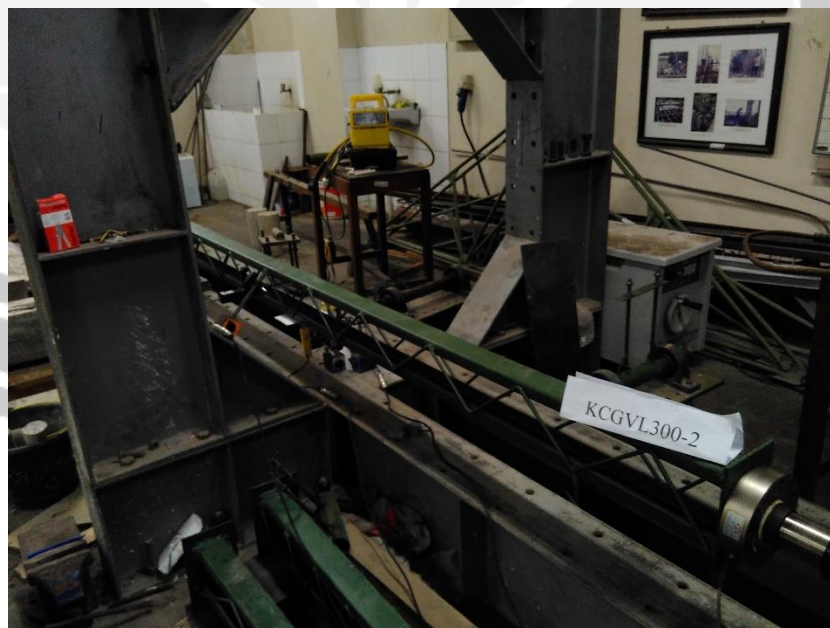
Pengujian Kolom Baja Profil C Ganda dengan Perangkat Tulangan Arah Diagonal (KCGVD300)
