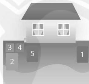
Jarak antara pompa dengan septik tank minimum 10 m
