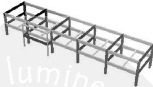
Gambar : VI.11. Elemen Balok dan Kolom Struktur
