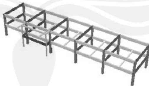
Gambar : V.13. Elemen Balok dan Kolom Struktur
