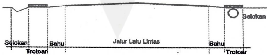
Gambar 3.2. Penampang Jalan Tipikal Dengan Trotoar
