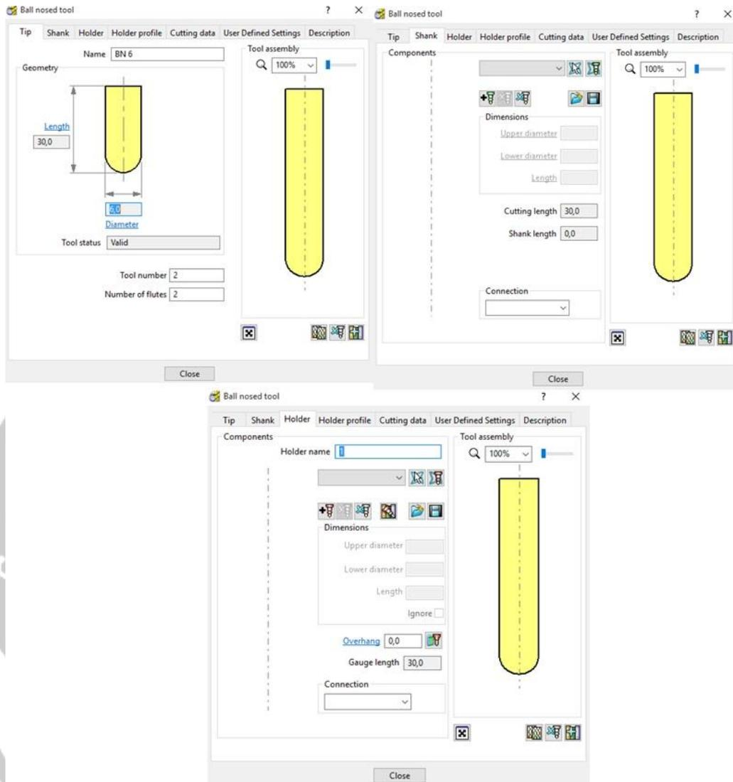
**Gambar 2.6. Pengaturan *Ball Nose Cutter* Ø6 pada Percobaan Pertama**
