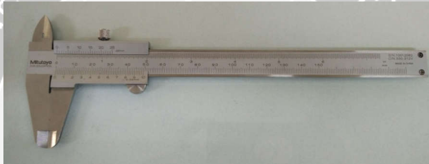
Gambar 3.11. Jangka Sorong Mitotoya 0.02
