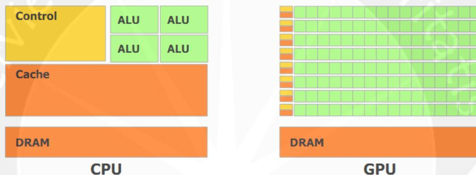
Gambar 2.5 GPU lebih banyak transistor ke pengolahan data. (nvidia, 2012)
