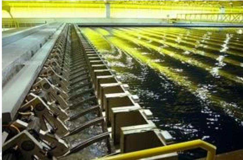
**Gambar 2.9** Pembuat Ombak Grid Kolam Uji Air Laut LabOceano
