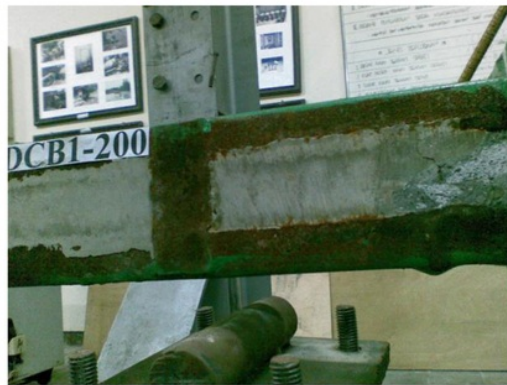
Gambar 2. Kegagalan kolom pendek dengan pengisi beton ringan
