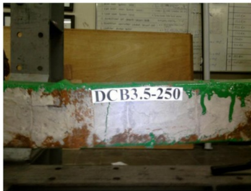
Gambar 5. Crushing pada beton pengisi
