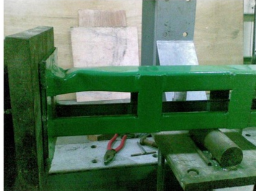
Gambar 1. Kegagalan kolom pendek tanpa pengisi beton ringan
