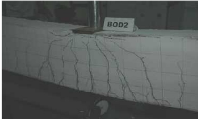
Gambar 12. Pola retak balok BOD2
