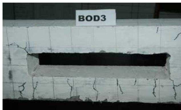
Gambar 16 Pola retak sekitar bukaan spesimen BOD3
