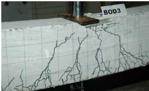
Gambar 13. Pola retak balok BOD3.
