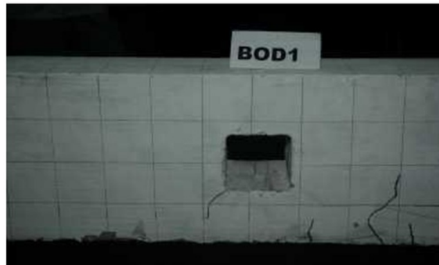
Gambar 14 Pola retak sekitar bukaan spesimen BOD1
