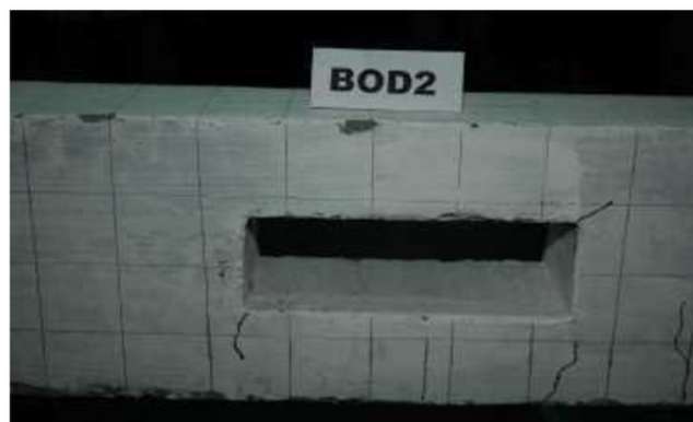
Gambar 15 Pola retak sekitar bukaan spesimen BOD2
