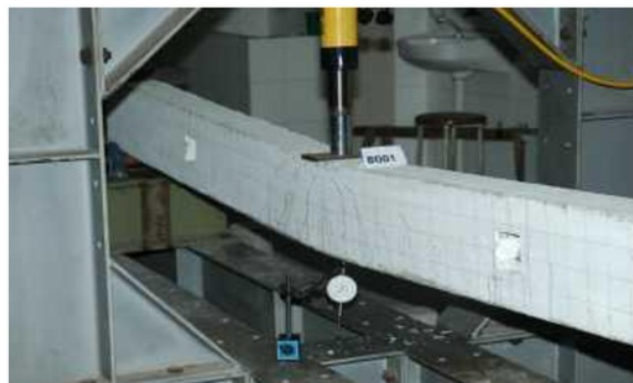
Gambar 11. Pola retak balok BOD1
