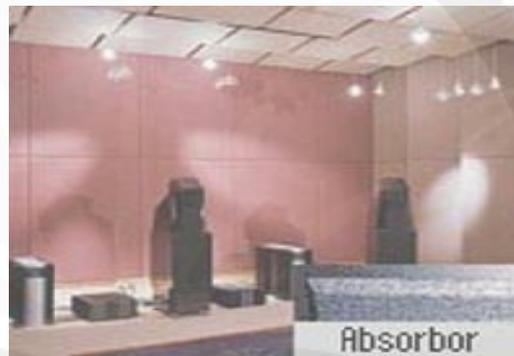
Gambar 2.37 Penerapan Panel Penyerap pada plafond dan dinding
