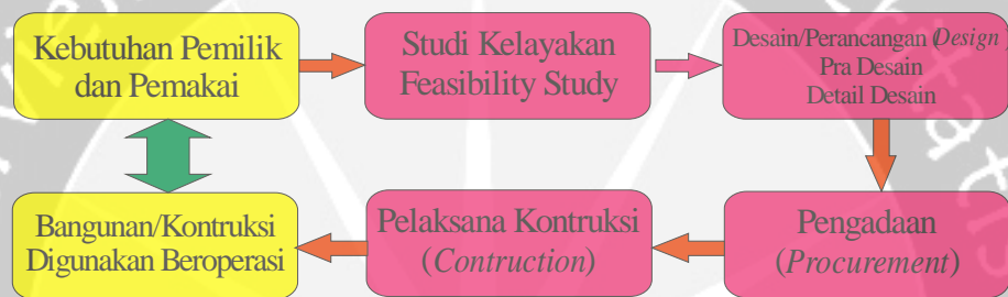
Gambar 2.1 Rangkaian Kegiatan Proyek Konstruksi
