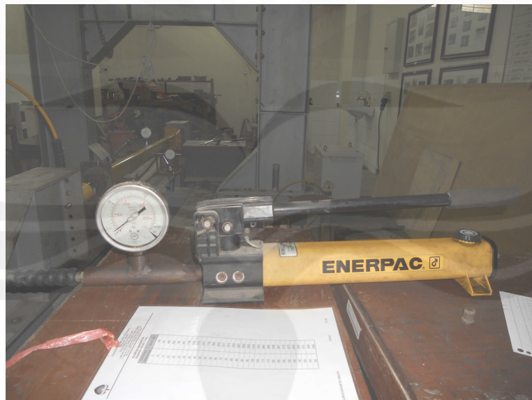
Gambar 19. Pembebanan Kolom Uji dengan Hidraulic jack
