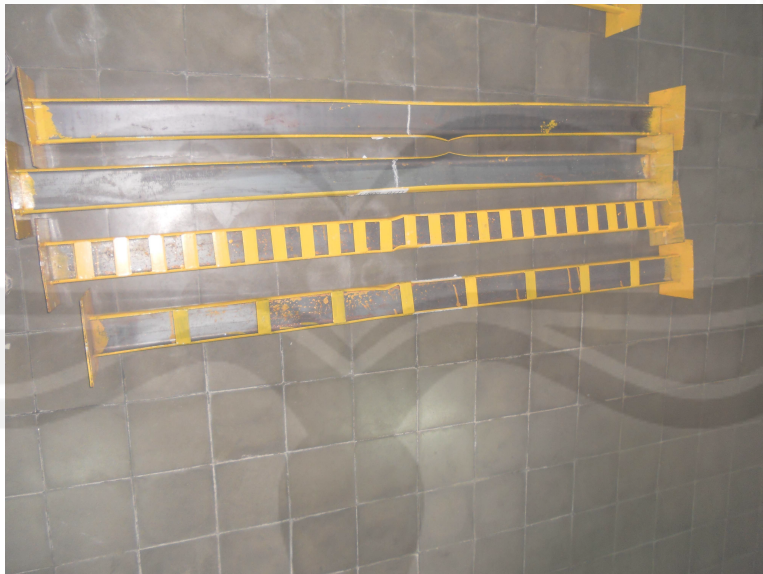
Gambar 20. A, B, C dan D Kegagalan Pada Kolom Setelah Pengujian
