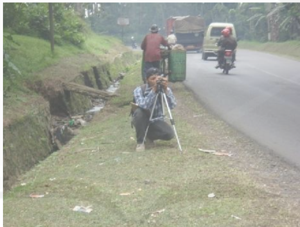
Pengukuran Beda Tinggi
