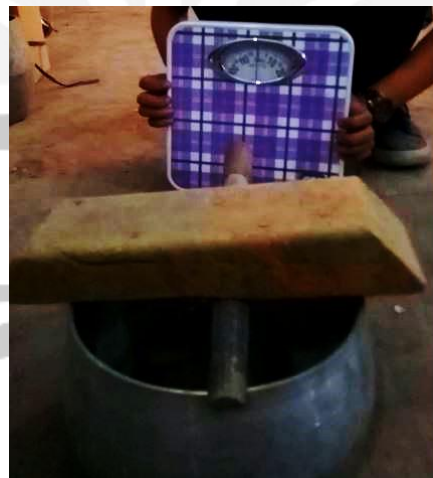
Gambar 5.3. Eksperimen Pengambilan Data Gaya Gesek Pengikiran Wajan
