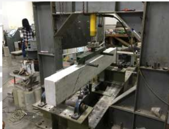
Pengujian Balok Beton Bertulang
