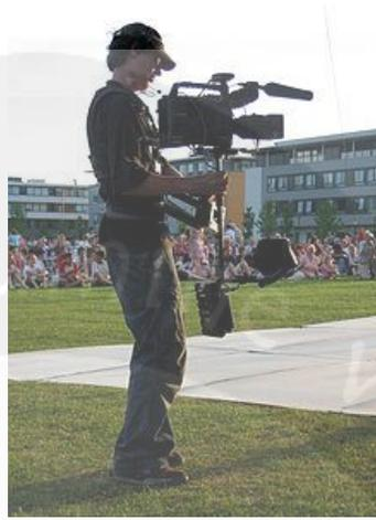
**Gambar 2.8.** Seperangkat kamera dengan *steadicam* yang dilengkapi dengan monitor.
