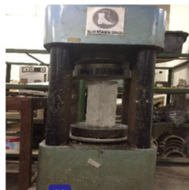
Gambar 5. Pengujian kuat tekan beton
