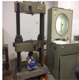
Gambar 7. Pengujian kuat tarik belah beton
