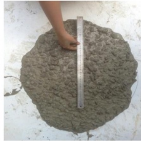
Gambar 3. Pengujian Slumpflow dan T_{500}
