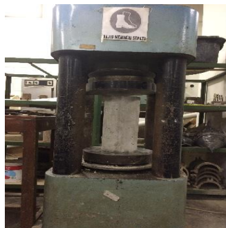
Gambar 5. Pengujian kuat tekan beton
