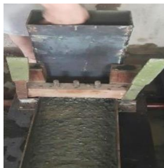
Gambar 4. Pengujian L-shape box
