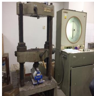
Gambar 7. Pengujian kuat tarik belah beton
