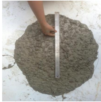
Gambar 3. Pengujian Slumpflow dan T 500
