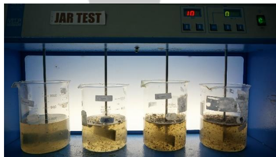
Gambar 25. Proses Koagulasi Dengan Jar Test
