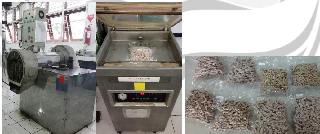
Gambar 30. Alat Ekstruder, Vaccum Sealer , dan Produk yang Dikemas
