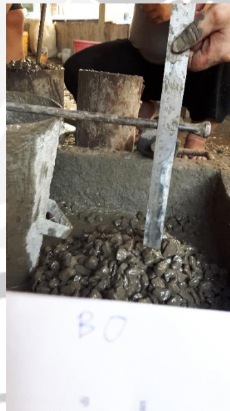
Pengujian Slump Beton Non Pasir Fas 0,4
