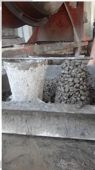
Pengujian Slump Beton Non Pasir Fas 0,3
