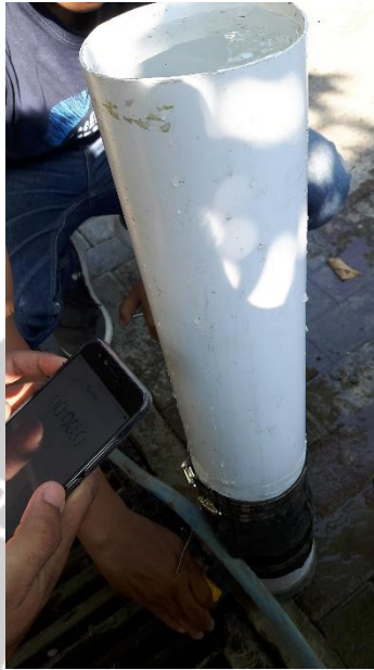
Pengujian Permeabilitas Beton Non Pasir Pada Umur 28 Hari
