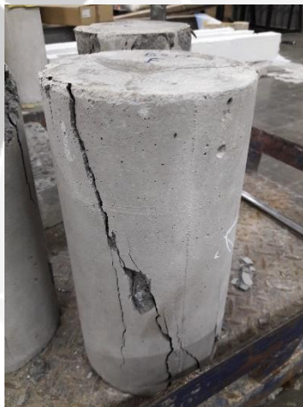
Hasil Pengujian Kuat Tekan Beton Normal
