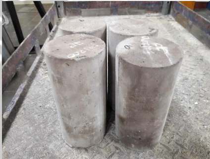
Benda Uji untuk Pengujian Porositas Beton Pasca Bakar
