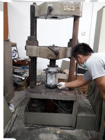
Pengujian Modulus Elastisitas Beton
