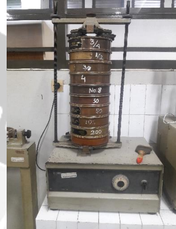
Pengujian Gradasi Butir Agregat Halus dan Kasar
