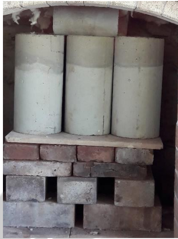
Proses Pembakaran Beton
