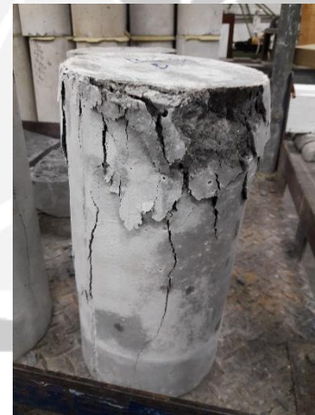
Hasil Pengujian Kuat Tekan Beton Serat Polypropylene
