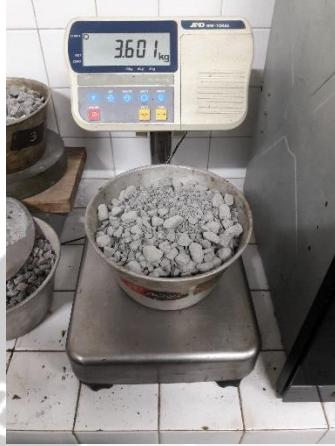
Penimbangan Hasil Uji Mesin Los Angeles Abrasion
