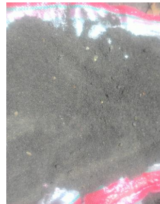
Pembuatan SSD Agregat Halus
