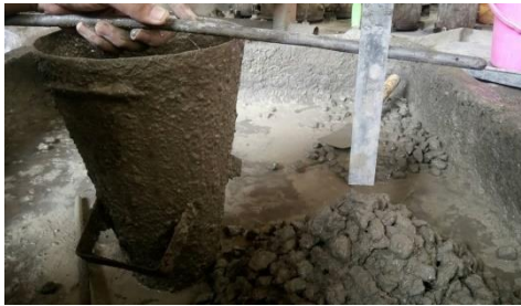
Pengukuran Nilai Slump
