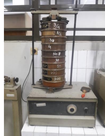
Pengujian Ayakan Agregat Halus dan Kasar
