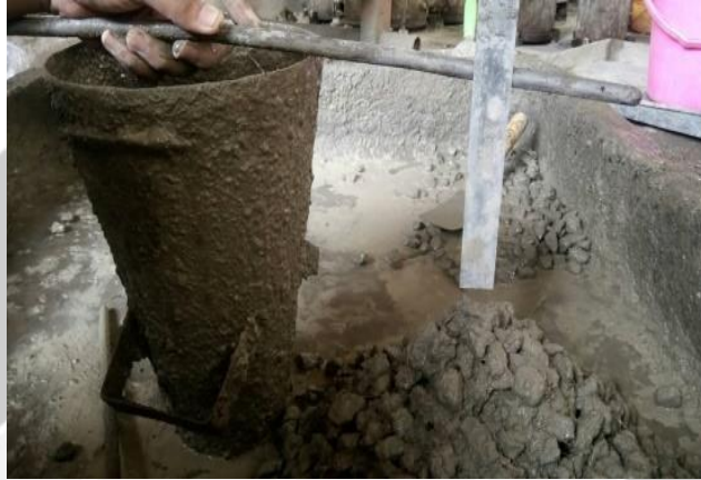
Pengukuran Nilai Slump
