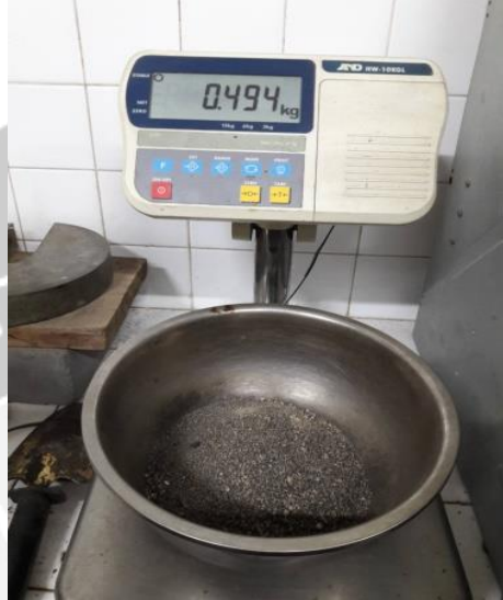
Pengujian Berat Jenis Agregat Halus
