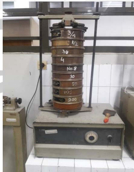
Pengujian Ayakan Agregat Halus dan Kasar
