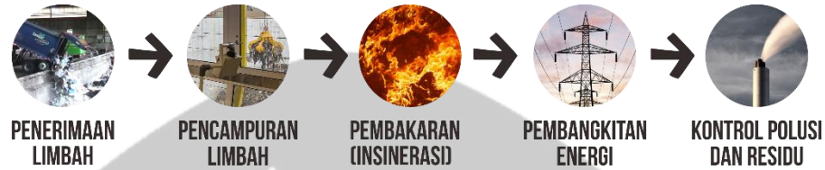
Gambar 6.4 Urutan proses pengolahan limbah menjadi energi
