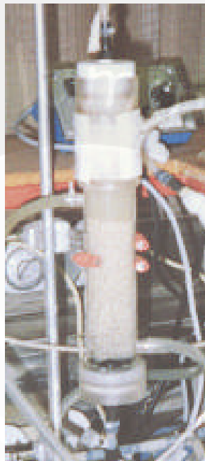
Gambar 3. Reaktor biofilm untuk proses industri biokonservasi peningkatan potensi reaksi kultur (Sumber: Joseph dkk, 2006)
