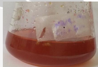
Gambar 26. Pengujian Kadar Metoksil setelah didiamkan 30 menit (Dokumentasi Pribadi, 2018)
