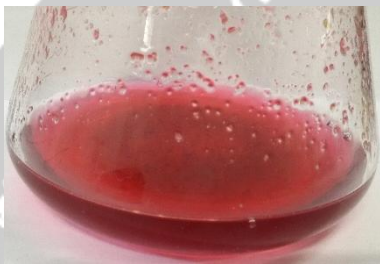
Gambar 25. Pengujian Kadar Metoksil dengan penambahan NaOH 0,25 N pada hasil Berat Ekivalen (Dokumentasi Pribadi, 2018)
