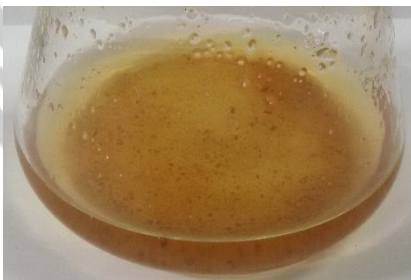
Gambar 27. Pengujian Kadar Metoksil setelah ditambahkan HCl 0,25 N (Dokumentasi Pribadi, 2018)
