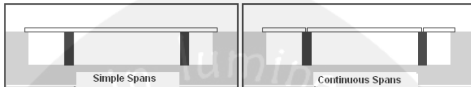
Gambar 2.1 Jembatan Balok Tipe Sederhana dan Menerus
