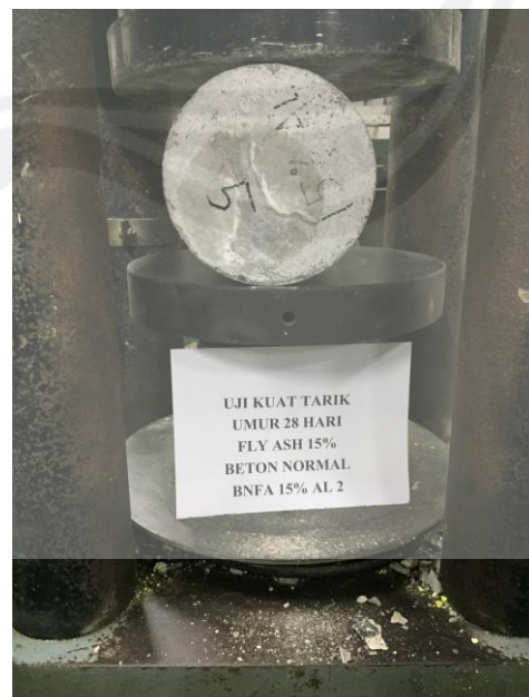
Gambar 8. Pengujian Kuat Tarik Belah
