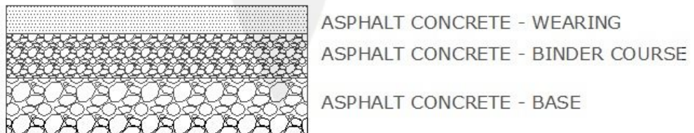
Gambar 2.1 Struktur Lapisan Aspal Beton (Laston)
