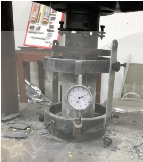
Pengujian Modulus Elastisitas Beton
