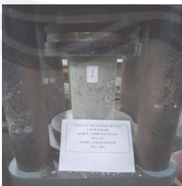
Uji kuat tekan beton
