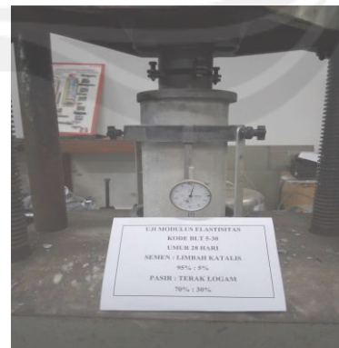
Uji modulus elastisitas beton
