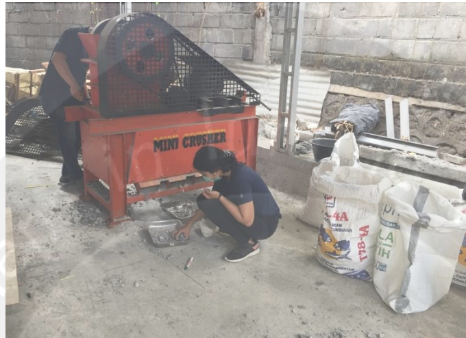
Proses Penghancuran Limbah Beton Menjadi Agregat
