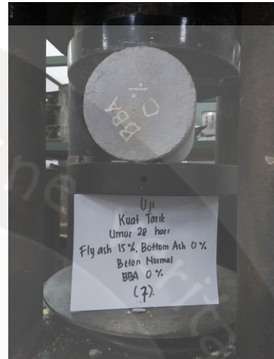
Pengujian Kuat Tarik Belah Beton
