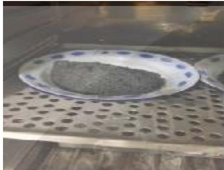
**Pengujian Kadar Air dan Penyerapan Agregat halus**
