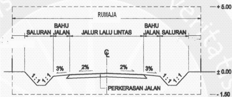
Gambar 2.4 Detail Melintang Saluran Samping
