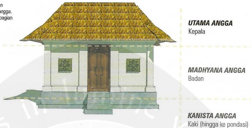
Gambar 3.4 Bagian-bagian Bangunan Berdasarkan Konsep *Tri Angga*
