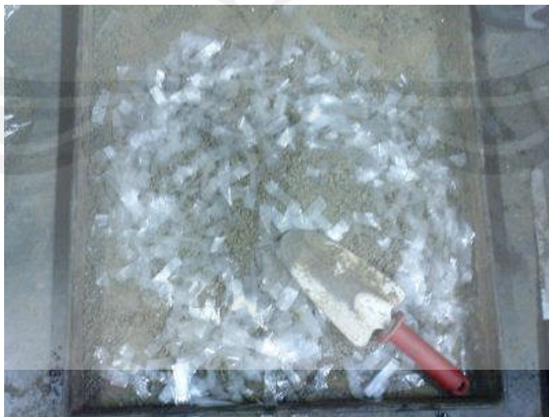
Gambar Pencampuran Tanah Dengan Plastik
